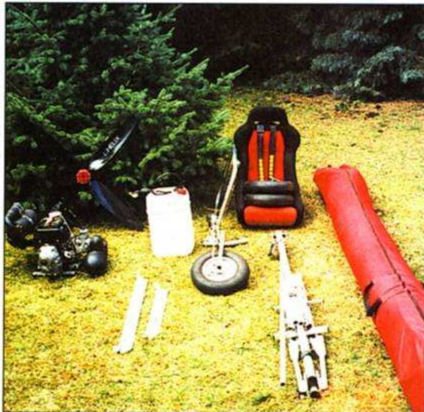
Sieht aus wie ein LEGO-Bausatz für Kinder ab zehn und passt locker in einen Pkw: Gestell, Sitzschale, Triebwerk, Flügel, Propeller, Rettungssystem. Foto: privat
